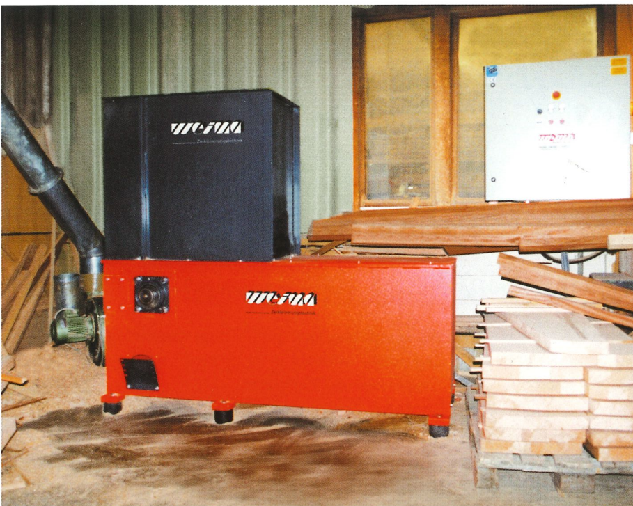
Zerkleinerer der Baureihe WL 4S, angeschlossen an eine Absauganlage
