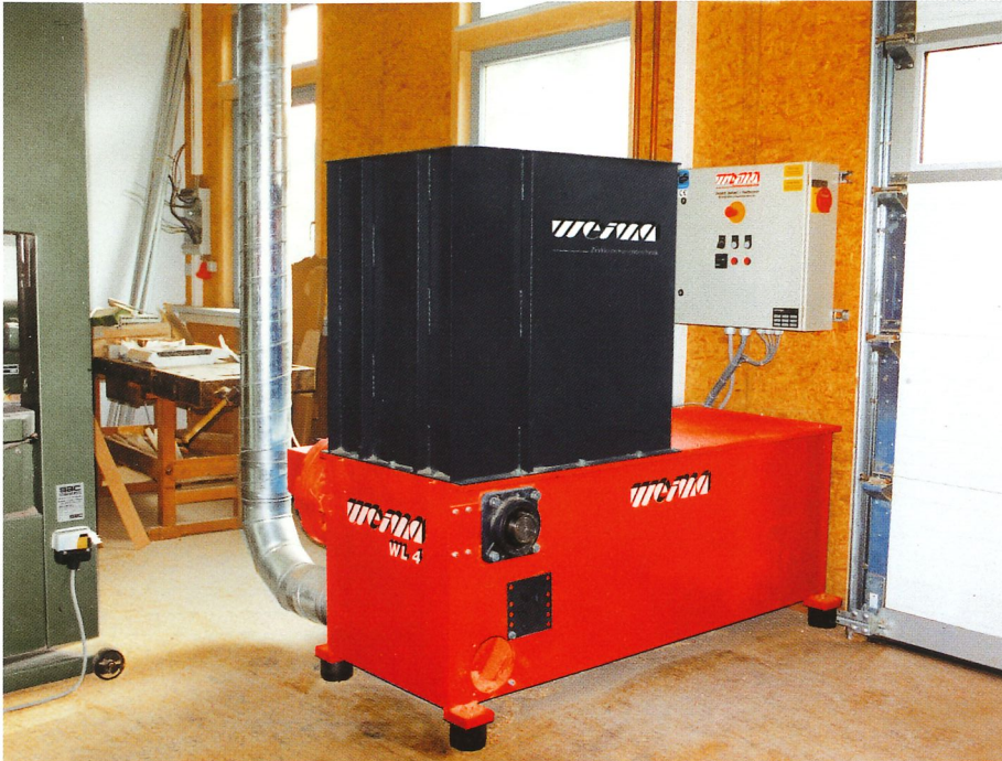
Zerkleinerer der Baureihe WL 4, angeschlossen an eine Absauganlage
