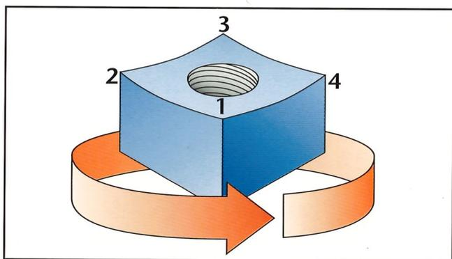
Schneidrotor mit 4mal drehbaren Schneidkronen - ergibt hohe Wirtschaftlichkeit. Leicht und schnell austauschbar (kein Aufschweißen notwendig)
