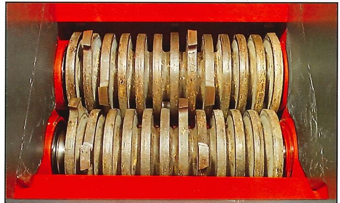
Hohe Durchsatzleistung durch 2 Messerwellen. Unempfindlich gegen Fremdkörper.
