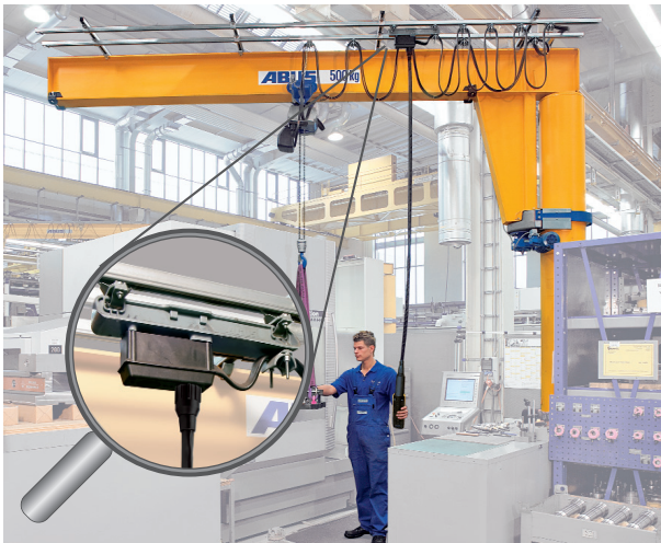
verfahrbare Bedienung (Bild 11)
