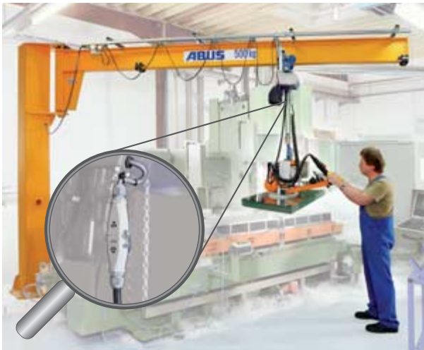
Schwenkran mit Vakuumgerät u. Stecker (Bild 13)
