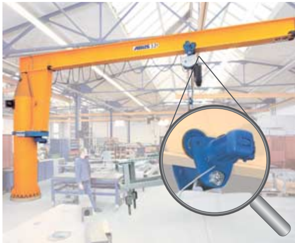
Katzfahren elektrisch (Bild 1)
