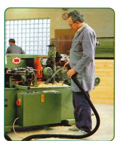
Der AL-KO Jet-Stream 27 für Handwerk und Gewerbe. Besonders geeignet für den Einsatz als mobiles Saugsystem zum Aufsaugen abgelagerter Stäube und für das Absaugen von Handmaschinen wie z.B. Oberfräsen, Handkreissägen. Der leistungsstarke Industrienaß- und trockensauger ist zudem sehr geräuscharm und verfügt über eine Volumenstromkontrolle mit optischer Anzeige bei Unterschreitung der Mindestluftgeschwindigkeiten im Saugschlauch.
