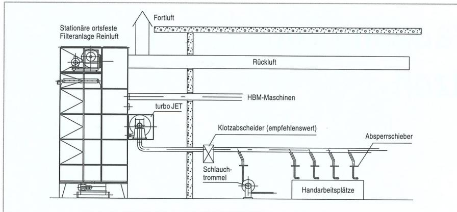
Die Hochleistungsventilatoren sind in einem schallisolierten Gehäuse eingebaut und können an eine bestehende Absauganlage angebaut werden.
