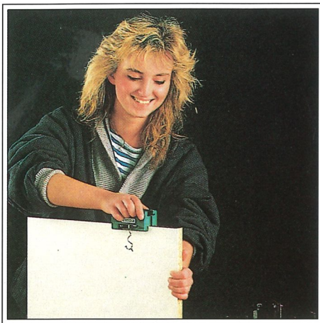
AU 93 Kantenbündigschneider für gerade Werkstücke. Kantendicke bis 1,0 mm.
