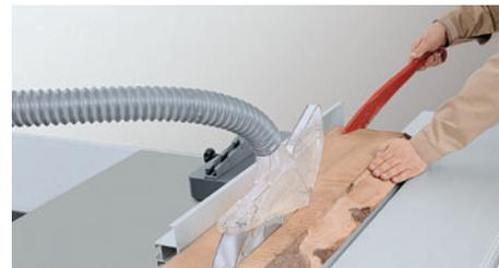
Desplazar la pieza a lo largo del tope-guía paralelo por la sierra giratoria; si es necesario, utilizar el taco deslizante.
