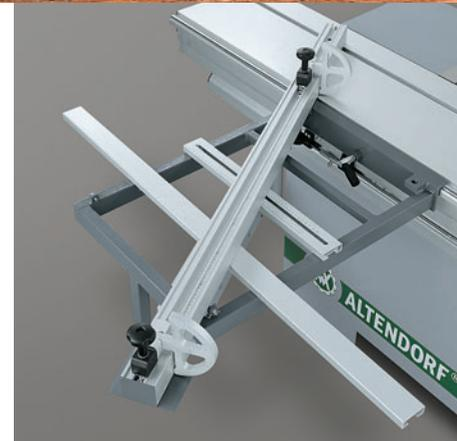
Tope-guía transversal de inglete: para cortes precisos de ángulos e ingletes en una única función. Gama de corte: 95–2600 mm. Ángulo de inclinación regulable sin escalonamiento de 0 a 49°.
