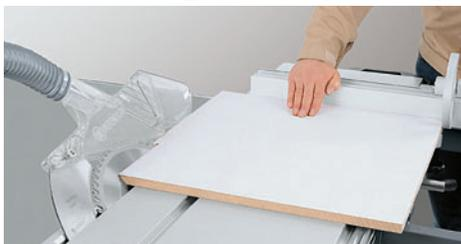
Inclinar la sierra de corte hasta la medida deseada y ajustar la pieza en el tope-guía transversal de inglete.
