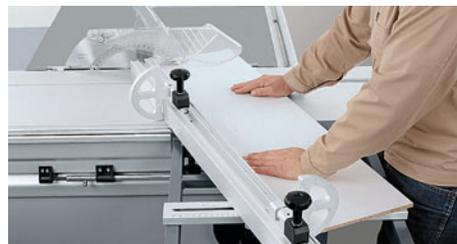
Corte a inglete con el tope-guía transversal de inglete.
