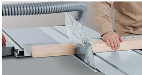
Posicionar el tope-guía paralelo delante de la sierra, ajustar a medida y cortar.
