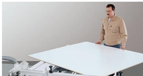
Girar la plancha en sentido contrario a las agujas del reloj y colocar el canto aserrado en el tope-guía transversal.
