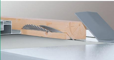
Sujetar la pieza bajo el terminal de apriete y biselar.
