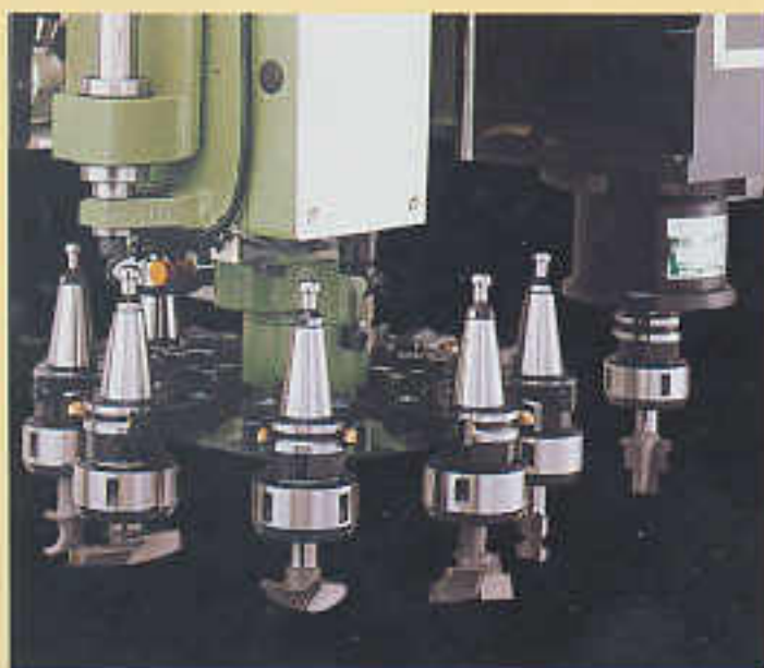
Hauptspindel 7.5kw 1000-18000 u/min. SK 30 Aufnahme, Magazinwechsler für 8 Werkzeuge.
