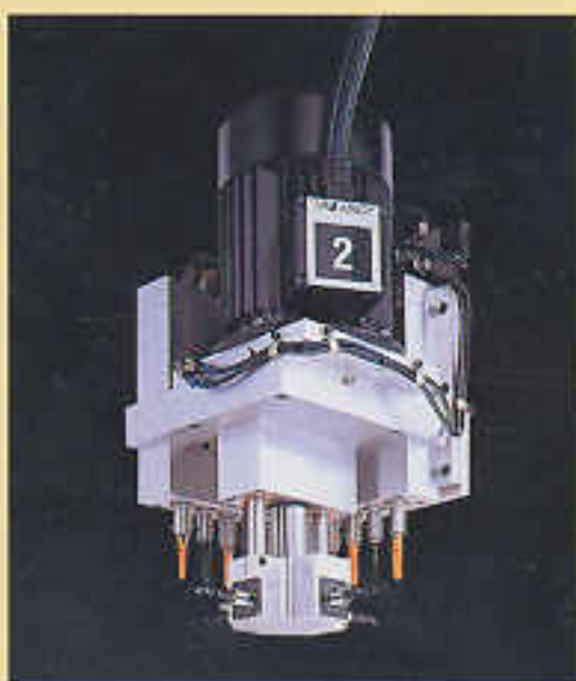
Multifunktionsbohraggregat. 11 Vertikalspindeln, einzeln abrufbar, integrierter 4-Spindel-Horizontal-Bohrkopf, 4500 u/min
