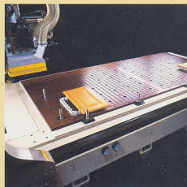
2 Vakuumzonen für Wechselbetrieb
