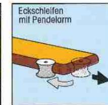
**Eckschleifen Typ WS-42** auch zum Eckfräsen als Typ **WF-42** verfügbar. Für Eckenradien oder Eckenfasen ungleicher Kanten über Eck.
