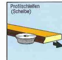
**Scheibenschliff Typ DS-40**, schwenkbar von vertikal ( $= 0$ ) bis  $135$  Grad. Über Frequenzumrichter auch zum Fräsen bis zu  $n = 10.000$  Upm.
