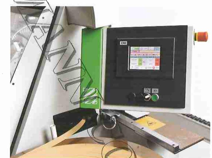
Contrôle Numérique TS06 avec écran LCD graphique couleurs de 6" touch screen. Il est possible, sur demande, de monter sur la machine Akron 400 TS10 de 10".
