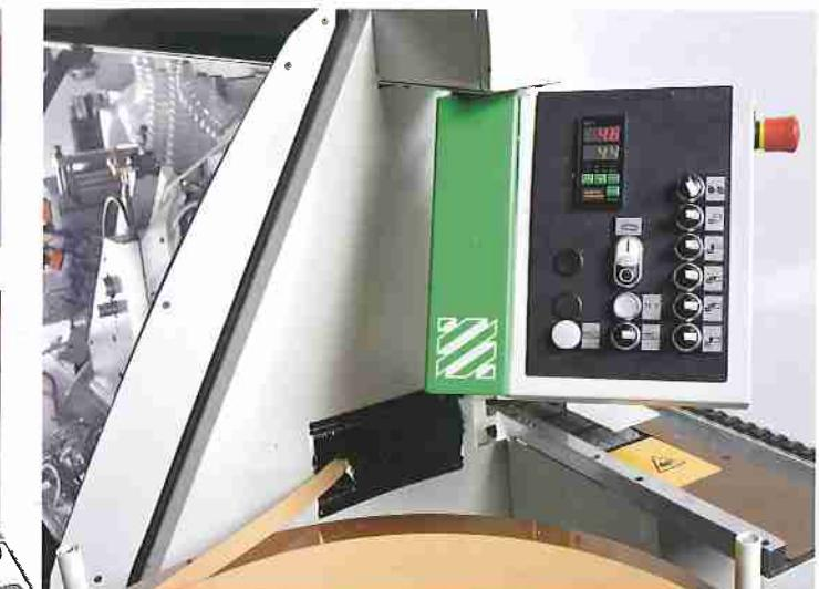
Système de contrôle à relé avec tableau de commande orientable en position ergonomique.
