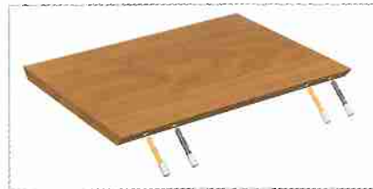
Exemples de perçages inclinés. Ejemplos de perforación inclinado.
