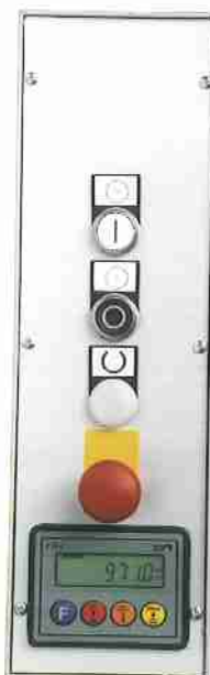
Detail der Digitale Massaszeigen für horizontale Maße
