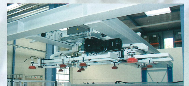
Saugtraverse mit Trennsaugern Vacuum Traverse with separating cups
