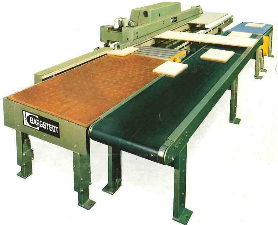
Die im Bild gezeigte Kantenanleimmaschine ist die Brandt KS 20.
