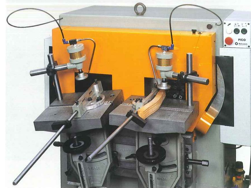
Regolazione posizione bancali: verticale, trasversale ed inclinata. Adjustment of table-position: vertical, transversal and inclined. Réglage de la position des tables: verticale, transversale et inclinée.
