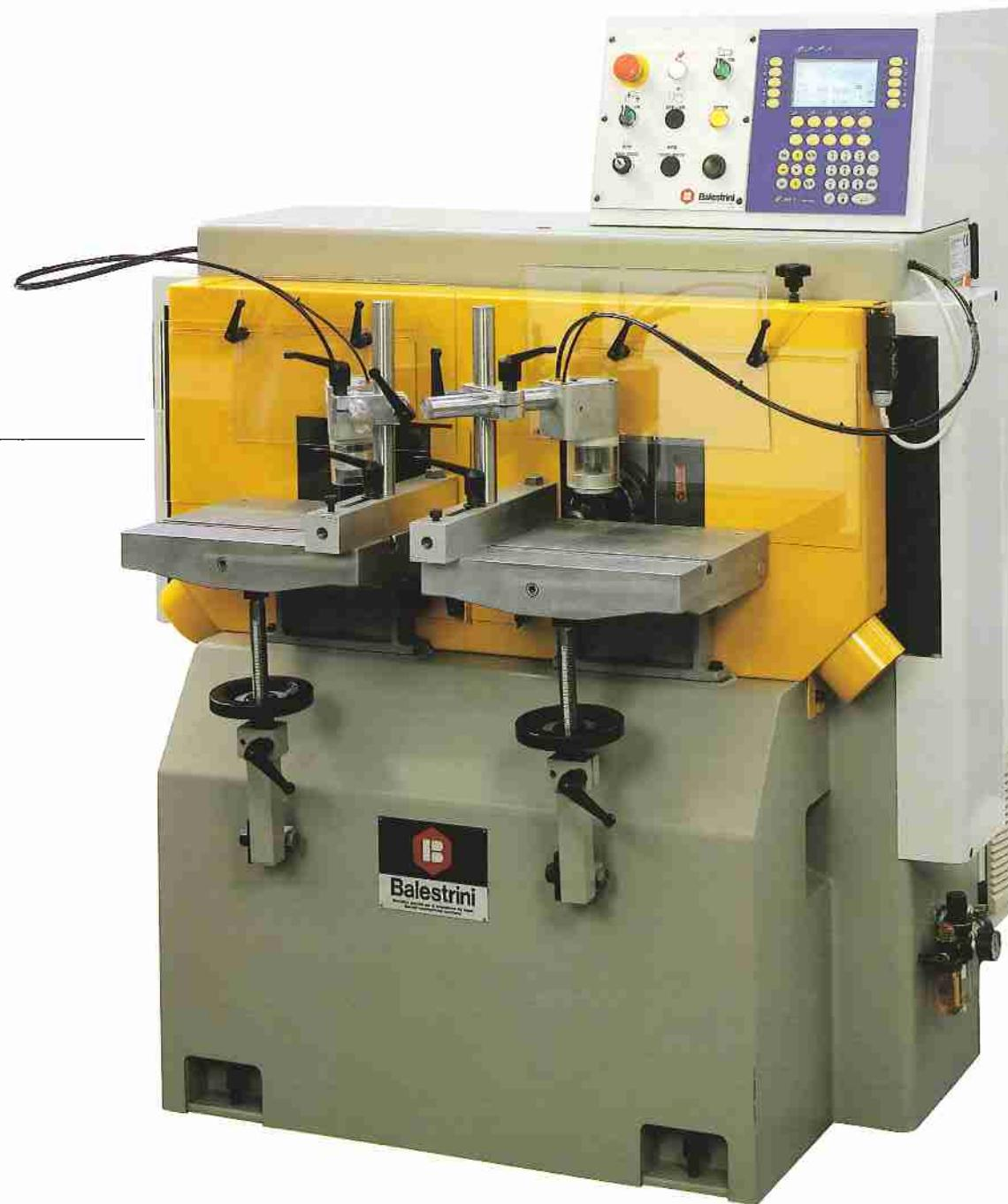
La tenonatrice stendente a controllo numerico mod. PICO/CN è la soluzione più moderna oggi disponibile per chi ha la necessità di produrre tenoni stondati, sia quando si debba realizzare qualche prototipo o piccola serie, che nel caso di produzione in serie importanti.
