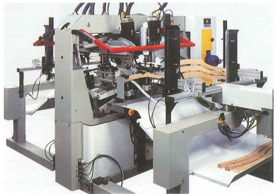
Vista generale e particolare di PRAGMA-TOP con Caricatori Automatici APPR e Sistema di posizionamento intelligente VB2, che può controllare fino a 50 assi.
