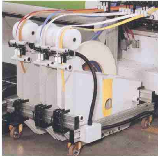
Edges magazine for coils. Magasin chants en rouleaux.
