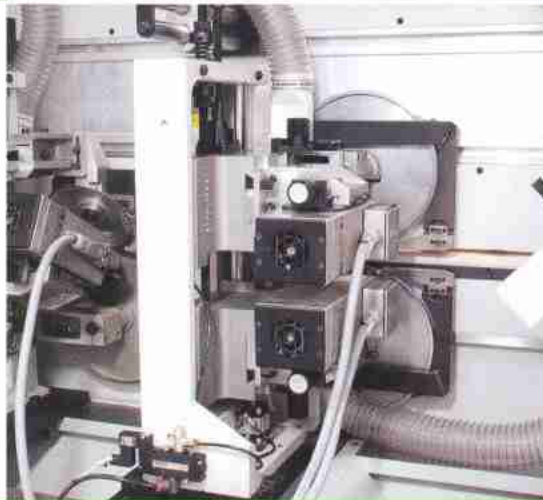
Rough-milling unit. Affleurance dégrossissage.
