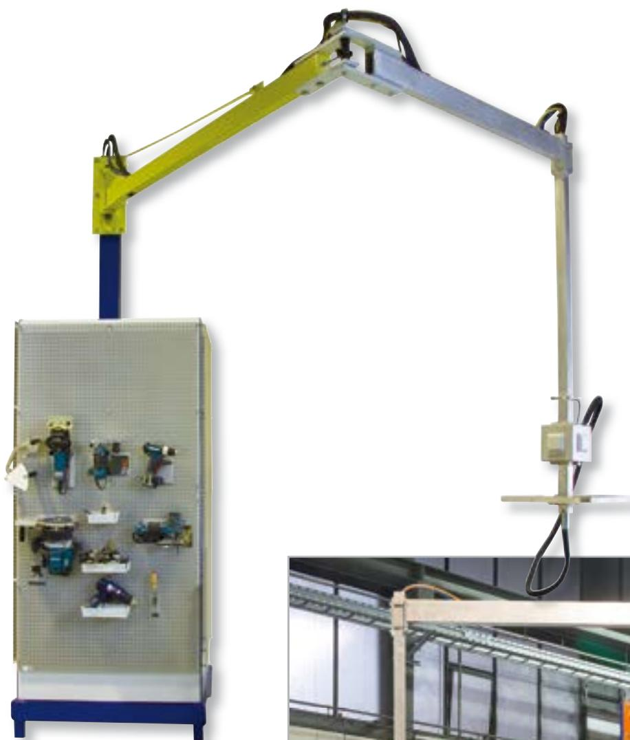
Der SERVANT versorgt Arbeitsplätze mit unterschiedlicher Energie, ohne störende Kabel und Leitungen am Fußboden.
