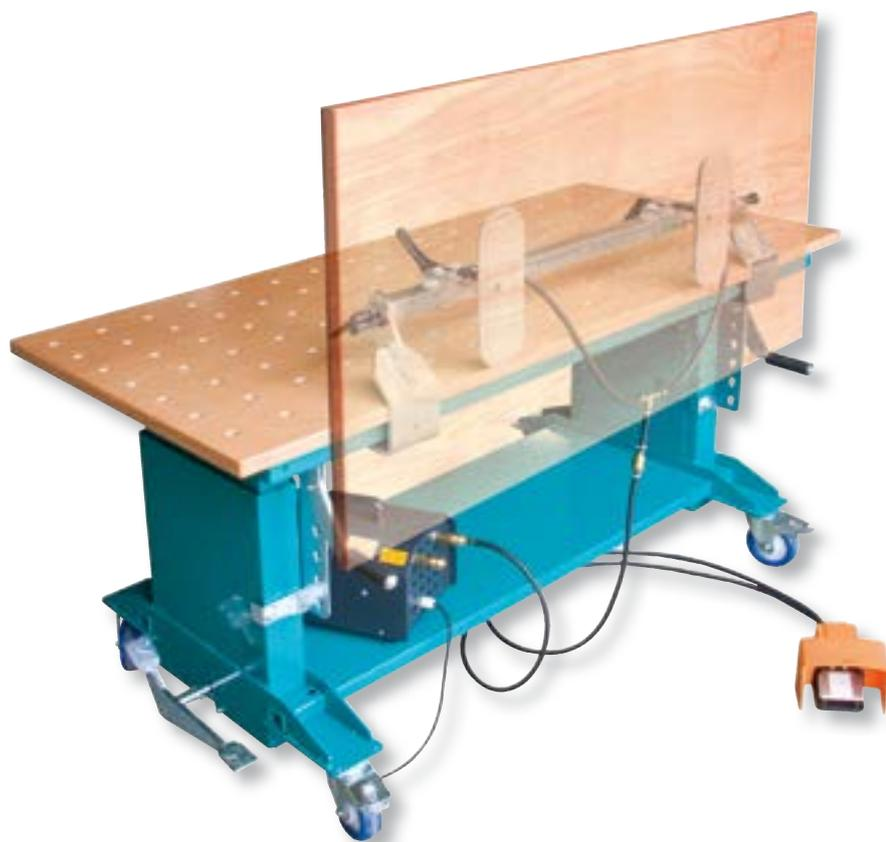
Der SUPPORTER arbeitet mit einem integrierten Hydrauliksystem und ist somit unabhängig von Versorgungsleitungen.
