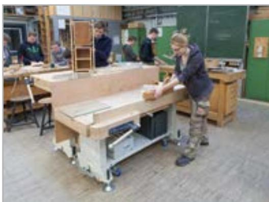
Der Hobelbanktisch mit 120 mm Stärke verfügt über Vorder- und Hinterzangen sowie Bohrungen auf der Tischfläche und an der Stirnseite.
