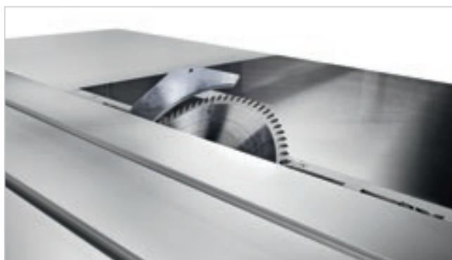
Il carro scorrevole si divide in due parti: la base scorrevole e il piano scorrevole. Entrambi sono in alluminio anodizzato di alta qualità e lavorati da un centro di lavoro a controllo numerico ad alta precisione. Questo garantisce al carro scorrevole affidabilità e accuratezza.
