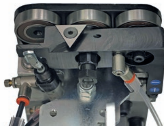
Il Gruppo Rachiacolla che rimuove gli eccessi di colla nella parte superiore ed inferiore del pannello.
