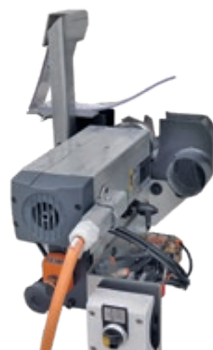
Il Gruppo Fresatore permette di realizzare la scanalatura e la fresatura sulla superficie inferiore del pannello.
