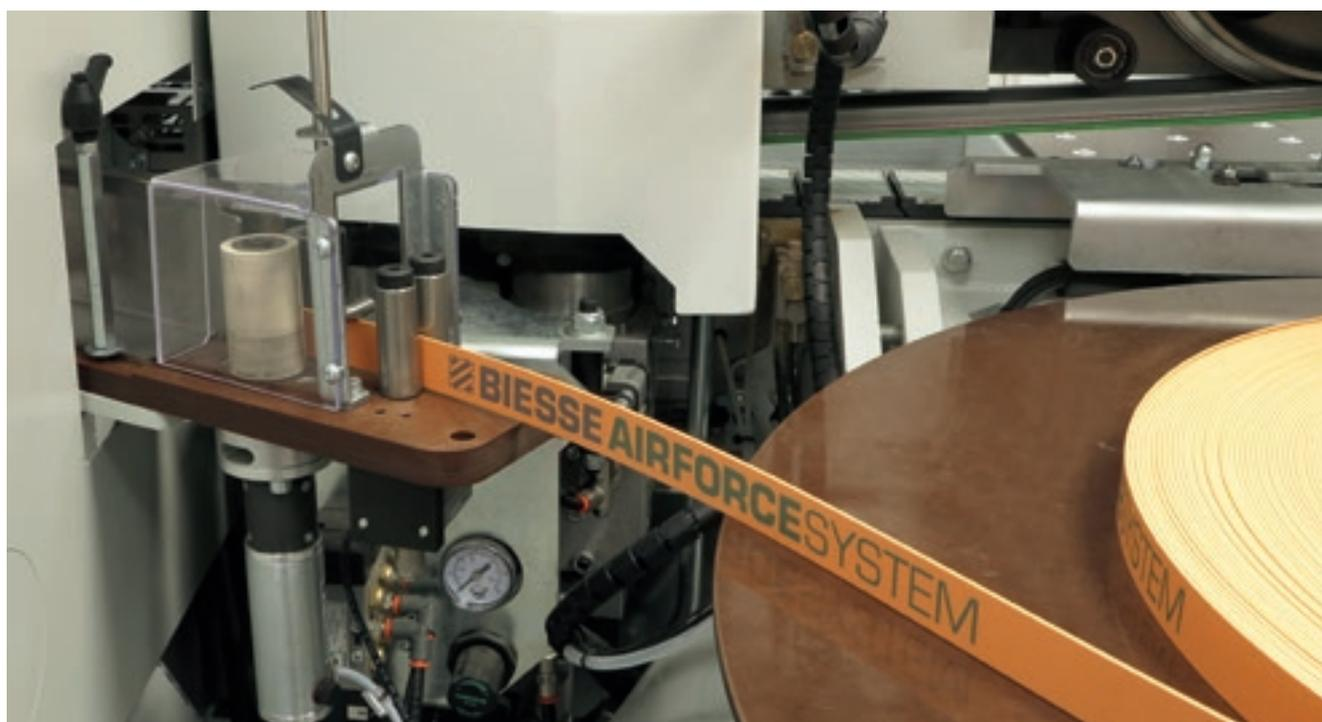
**Caricatore automatico da monorotolo**, permette il cambio rapido del bordo senza la necessità di aprire le cabine. **Sensore ottico** per il rilevamento del corretto posizionamento del bordo. (opz)
