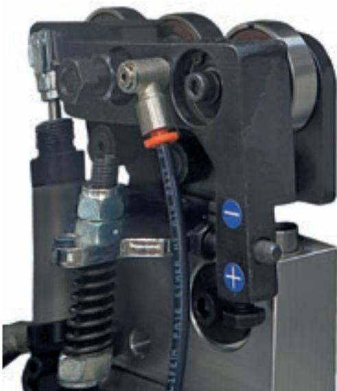
Il **Gruppo Raschiacolla** per rimuovere gli eccessi di colla nella parte superiore ed inferiore del pannello, è l'unico sul mercato dotato di 4 cilindri pneumatici per un'elevata qualità di finitura.
