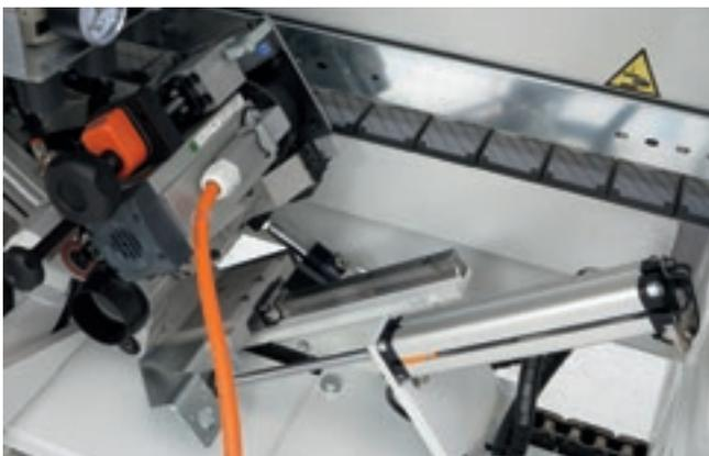
Il Gruppo Arrotondatore multifunzione a due motori consente di applicare una raggatura anche nella parte superiore e inferiore del pannello, oltre che in testa e in coda.
