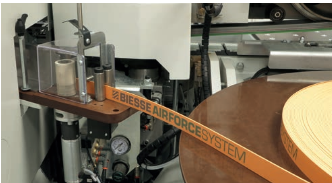
Carregador automático de rolo único , que permite a troca rápida da orla sem necessidade de abrir a cabine. Sensor ótico para a detecção do correto posicionamento da orla. (opc.)
