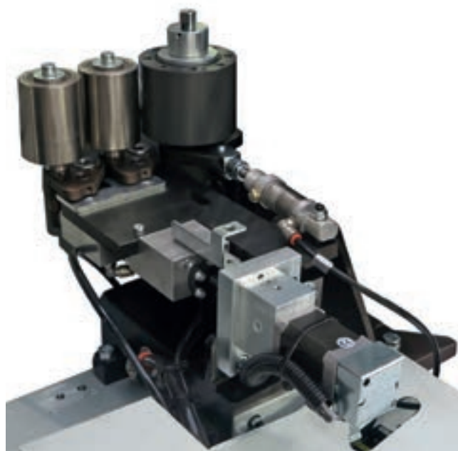
Dispositivo para a configuração automática do grupo de acordo com a espessura da orla. (opc.)
