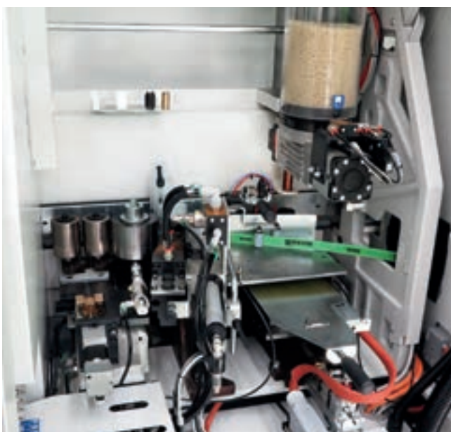
Grupo de cola para a aplicação automática de orlas em rolo e fitas de 0,4 a 12 mm.
