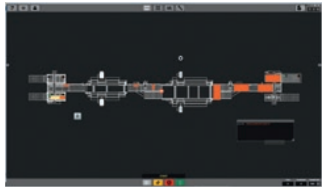
Stufenweise Synchronisierung des Programms je nach dem zu bearbeitenden Werkstück. Damit werden Leerzeiten der Linie vermieden.
