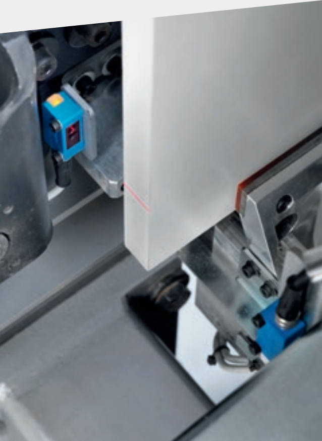
激光扫描系统可检测板材的初端和末端，以设备补偿尺寸误差、校正板材的X尺寸。
