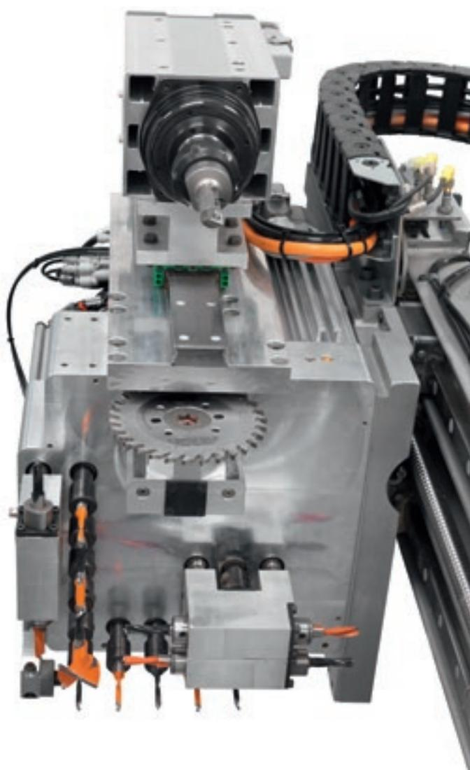
Возможна поставка фрезерных устройств от 4,5 до 5,5 кВт и сверлильных голов от 17 до 23 инструментов.
