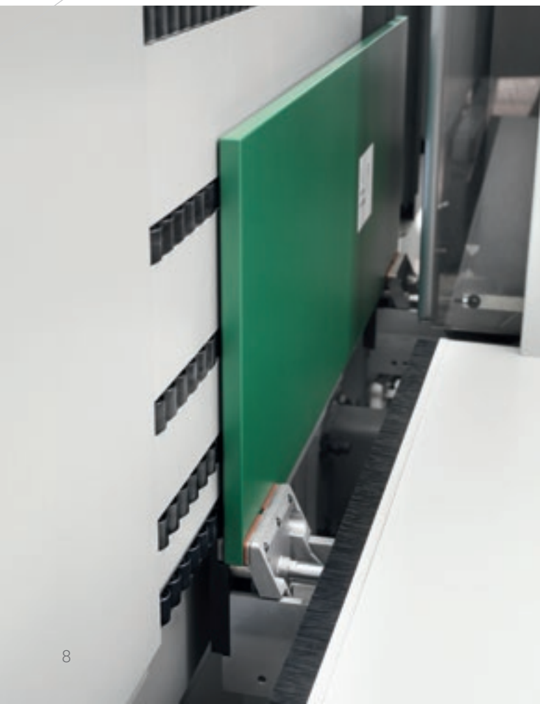
Magazzino a 8 posizioni che permette di gestire diverse tipologie di aggregati in grado di aumentare la versatilità della macchina.
