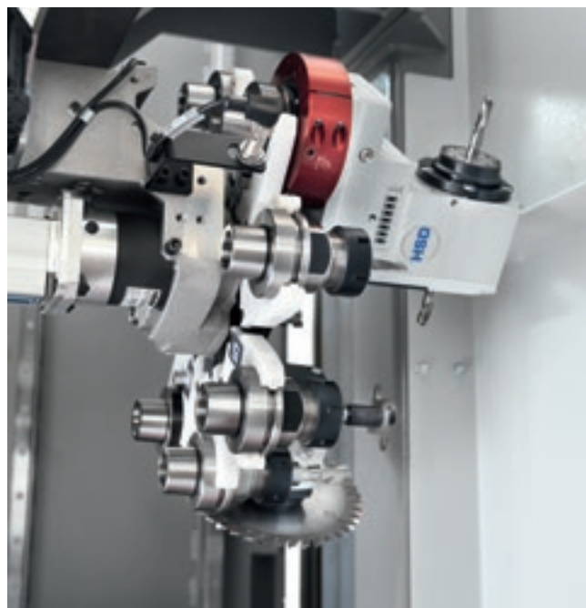
Magazzino a 8 posizioni che permette di gestire diverse tipologie di aggregati in grado di aumentare la versatilità della macchina.
