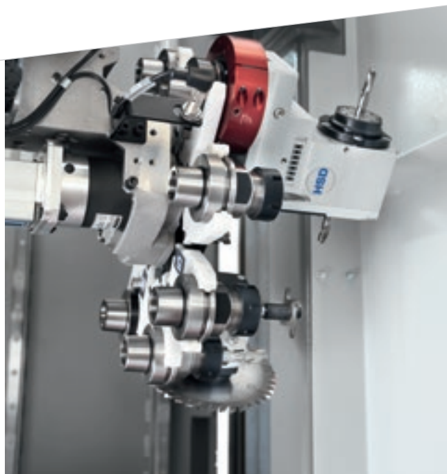
Магазин на 8 позиций позволяет размещать различные системы.
