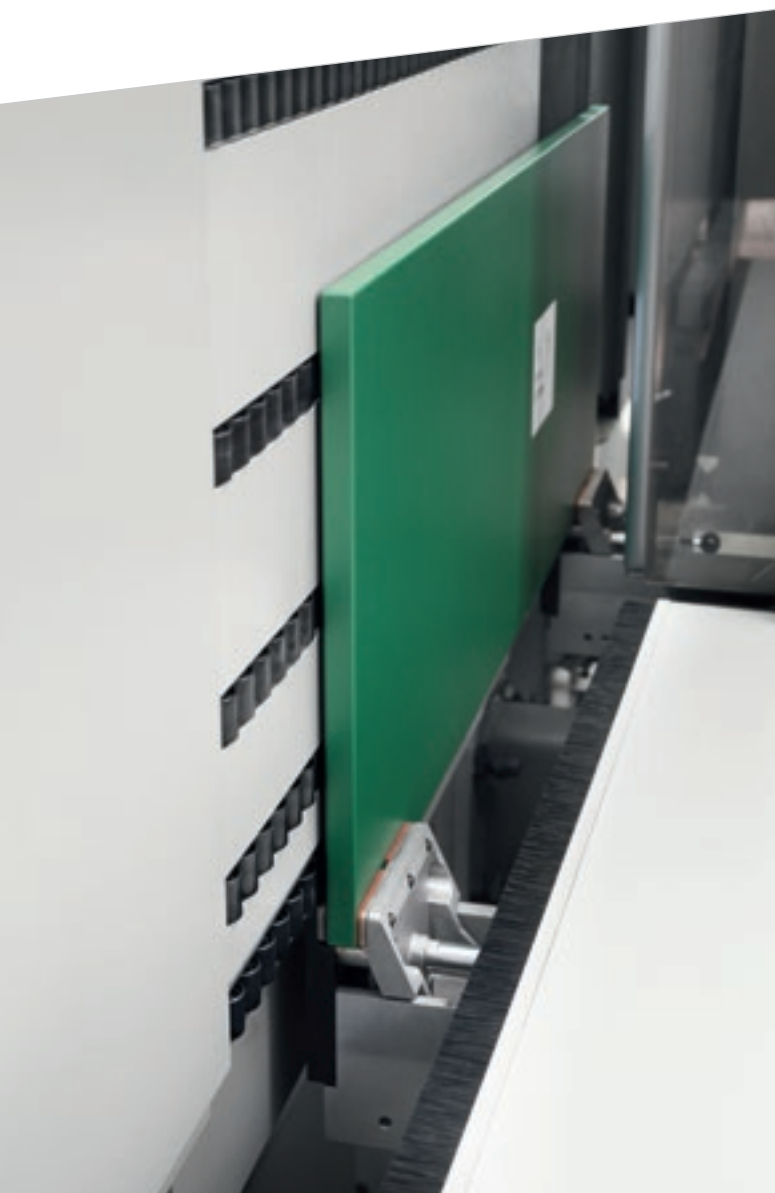
Магазин на 8 позиций позволяет размещать различные системы.
