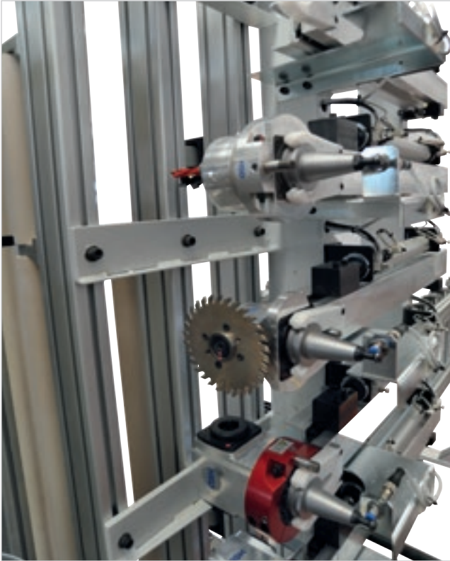
Magazin mit 5 Positionen, das mit Fräs- werkzeugen und Aggregaten bestückt werden kann.
