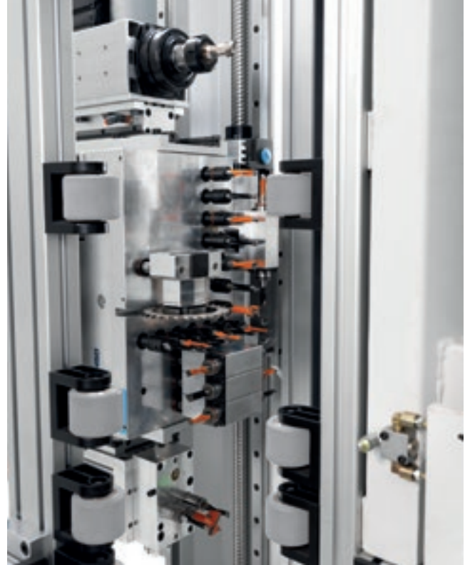
Standardbohrkopf mit einzeln abrufba- ren Spindeln und Nutsäge - Durchmes- ser 120 mm. Optional sind eine Elektros- pindel mit 4,5 kW und einer Drehzahl von 18.000 U/Min, sowie eine Sonderboh- reinheiten für Topfbänder im Programm.
