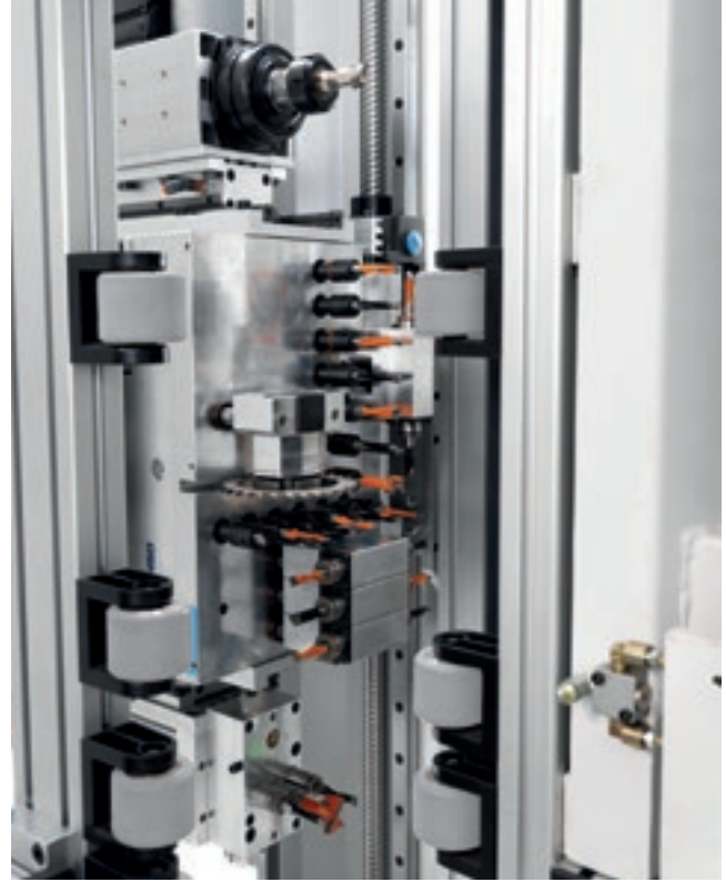
Grupo estándar con mandriles independientes con sierra \varnothing 120 mm. El grupo prevé como opcional un electromandril de 4,5KW de 18.000 rpm y un grupo taladro cremallera configurable.
