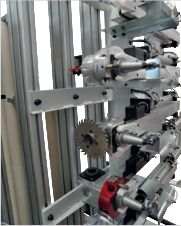
Magasin à 5 positions pouvant être équipé de cônes frontaux et d'agrégats renvoyés.
