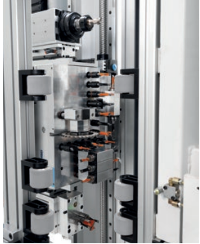
Groupe standard à broches indépendantes avec lame Ø 120 mm . Le groupe prévoit en option une électrobroche de 4,5KW à 18 000 tr/min et un groupe de perçage pour charnière configurable.
