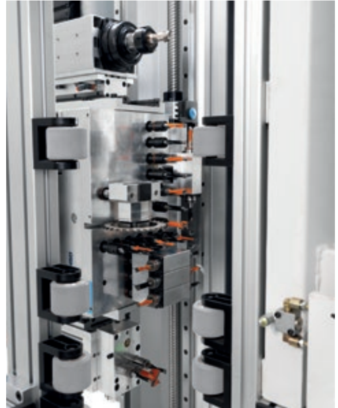
Gruppo standard a mandrini indipendenti con lama Ø 120 mm . Il gruppo prevede come optional un elettromandrino da 4,5KW da 18.000 rpm e un gruppo foratura cerniera configurabile.
