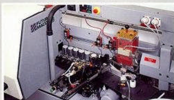
Zona di alimentazione, incollatura e pressione del materiale di bordatura. Edge material feeding, glueing and pressure zone.
