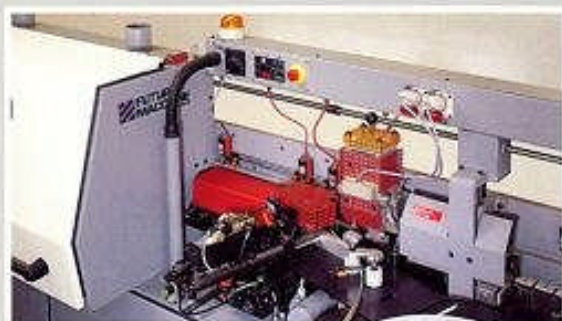
Vasca colla con contenitore di prefusione. Glueing unit with premelt glue container.
