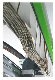
Seitlicher Schutzbänder zum Schutz der Arbeitsgruppe, mobil, um mit maximaler Geschwindigkeit in vollkommener Sicherheit zu arbeiten.
