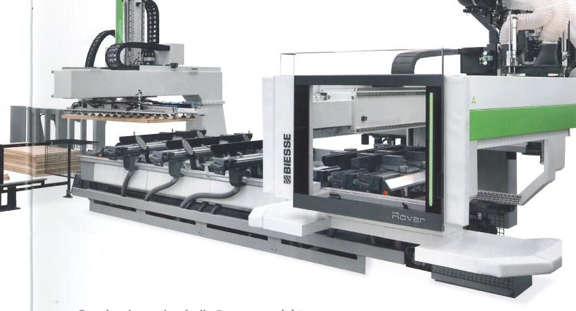
Synchro kann durch die Bezugsvorrichtung des Stapels und den Vorfluchtungszyklus der Platte, der in verdeckter Zeit während das Rover Arbeitszentrum die vorherige Platte bearbeitet, durchgeführt wird, Stapeln mit unterschiedlich großen Platten bearbeiten.
