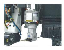
Die Multifunktions-Gruppe, die stufenlos über NC auf 360° positioniert werden kann, kann Aggregate für die Durchführung spezifischer Bearbeitungen aufnehmen (Aussparung für Schloss, Sitze für Scharniere, horizontale Tiefbohrung, Kappen usw.).
