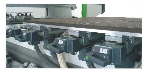
Alle Funktionen und die Qualität einer echten Flachtischmaschine werden durch das CFT-System (Convertible Flat Table) gewährleistet und ermöglichen so Bearbeitungen von dünnen Platten, Nesting oder Folding auf einer Konsolenmaschine.
