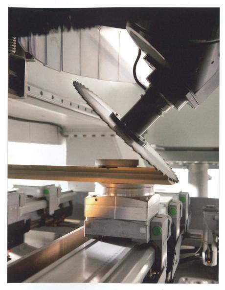
Die technologisch fortschrittliche Arbeitseinheit mit 5 Achsen ermöglicht die Bearbeitung von Werkstücken mit komplexen Formen und gewährleistet dabei Qualität und Präzision.
