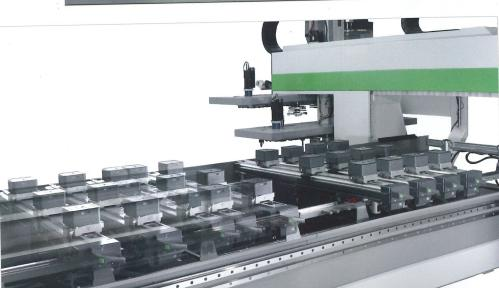
Hyperclamp-Spannvorrichtung für stabiles und präzises Spannen.
