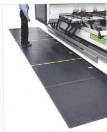
Die **berührungsempfindlichen Matten** gestatten der Maschine das Arbeiten bei konstanter Höchstgeschwindigkeit.
