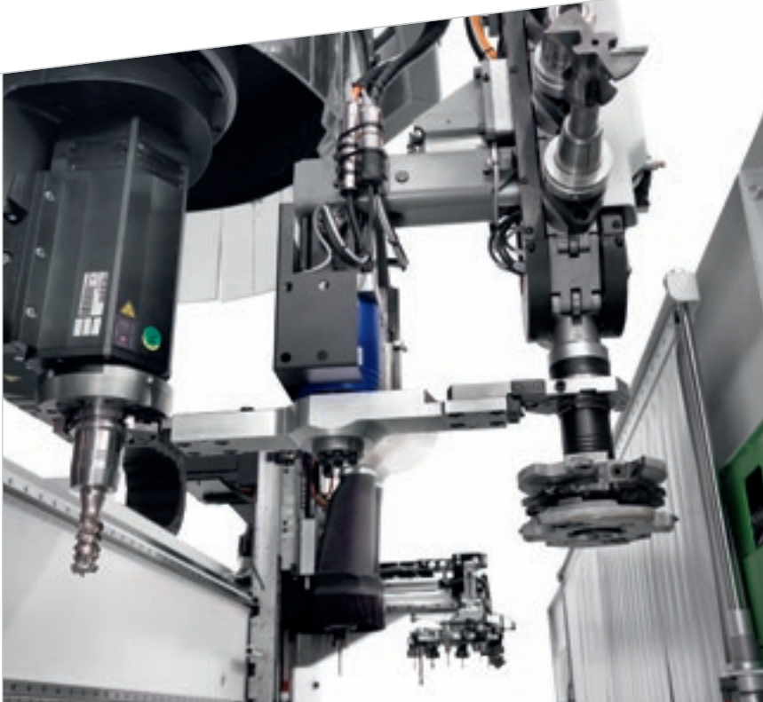
Senkrechttes Ketten-Werkzeugmagazin auf Y-Achse mit 10-15 Positionen.
