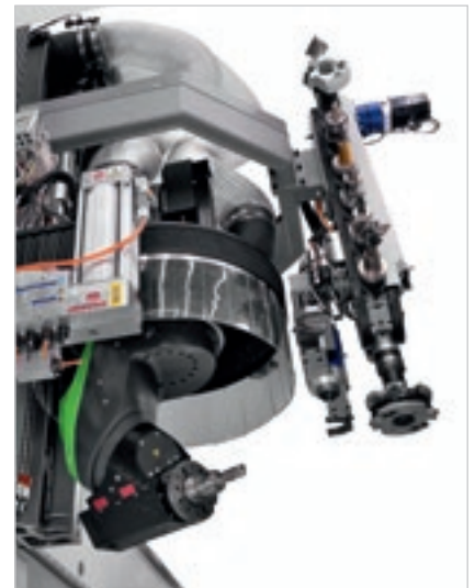
Magasin outils à chaîne verticale sur axe Y de 10-15 positions
