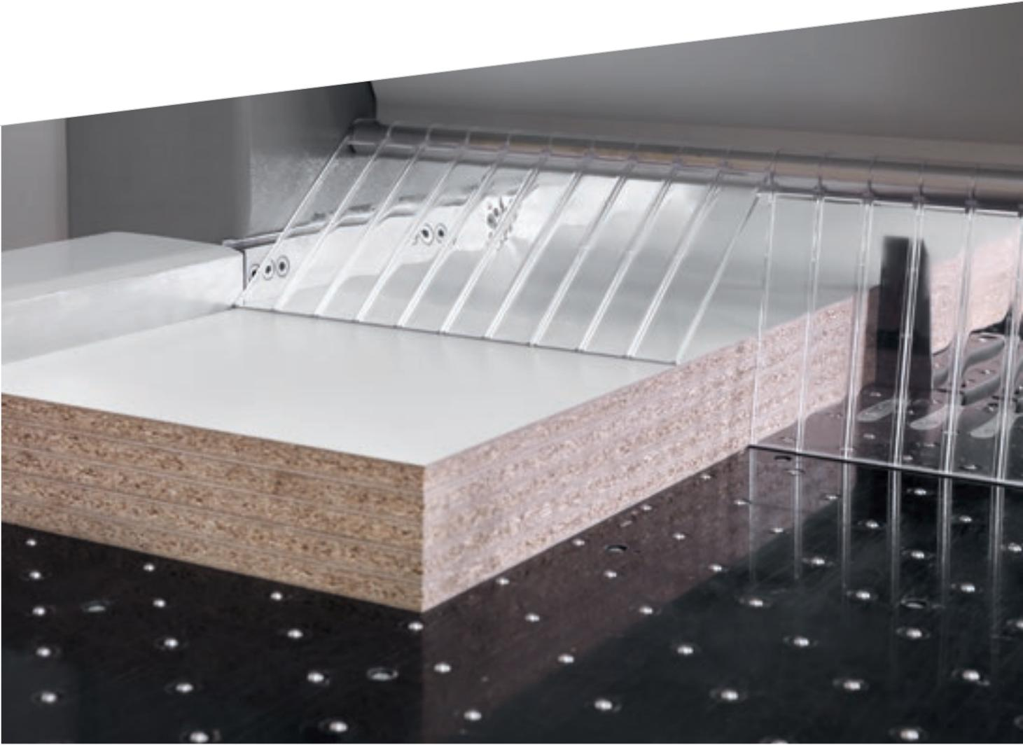
Der Anschlag für die seitliche Ausrichtung der Platten ist in den Quersägewagen integriert. Seine Beschaffenheit ermöglicht die perfekte Ausrichtung sogar von sehr dünnen und/oder flexiblen Platten und verkürzt dadurch die Zyklusdauer auf ein Minimum.
