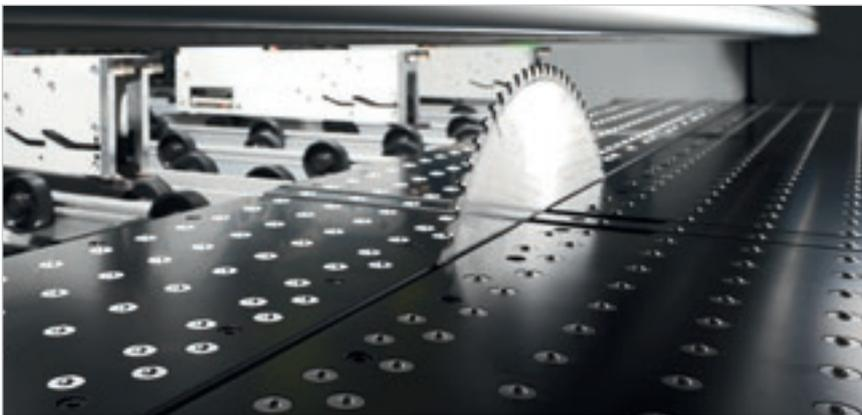
Die Luft bedühte Schnittlinie erleichtert das Bewegen empfindlicher Materialien. Diese Eigenschaft reinigt gleichzeitig die Fläche vor und hinter der Schnittlinie.
