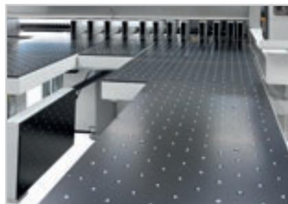
Platteneinspannvorrichtungen verhindern das Verrutschen des Pakets während der Drehung.
