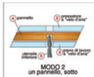
MODE 2 Bottom machining, one panel MODE 2 Une pièce, dessous ARBEITSMODE 2 Bearbeitung von unten, ein Werkstück
