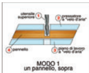
MODE 1 Top machining, one panel MODE 1 Une pièce, dessus ARBEITSMODE 1 Bearbeitung von oben, ein Werkstück
