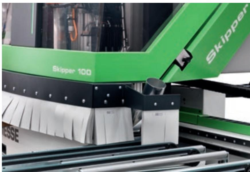
Звукоизолирующие картеры рабочих голов со шторками, защищающими от вылета пыли и обрезков, со встроенной вытяжкой.
