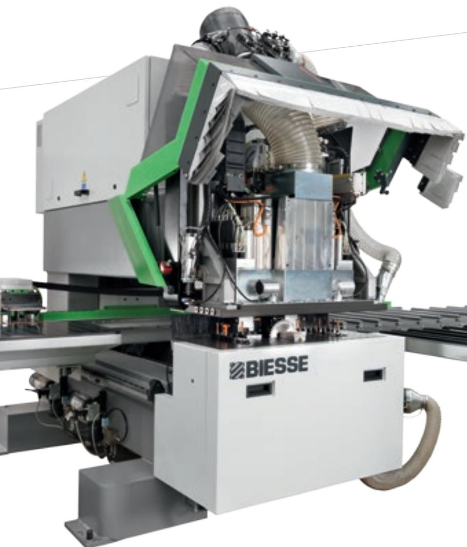
Станина обработана на металлорежущем обрабатывающем центре за одно позиционирование для получения максимальной точности. Фиксированные рабочие головы и подвижные панели обеспечивают точность и надёжность обработки, не зависящие от срока эксплуатации.
