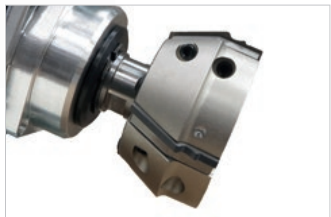
Utensili multiprofilo per diverse tipologie di bordo.
