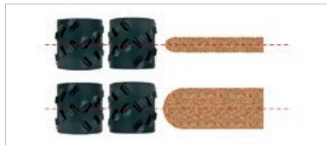
Le dispositif Autaset effectue la rectification et le centrage automatique de l'outil par rapport au panneau et améliore la qualité en diminuant les temps de paramétrage.
