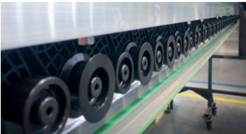
Le Presseur à courroie, de série dans la Stream A Smart, permet le passage du panneau sur la chenille afin de garantir une pression uniforme idéale même pour les revêtements les plus délicats.
