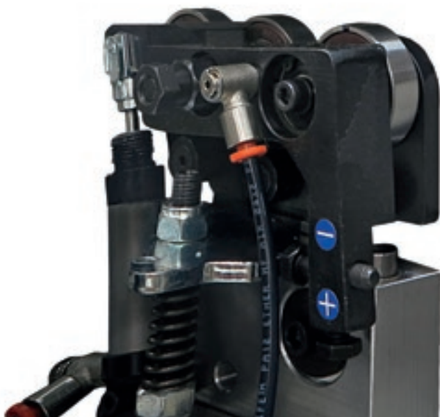
Группа клеевого скребка для удаления избыточного клея из верхней и нижней поверхностей панели, единственная на рынке, имеющая 4 пневмоцилиндра для высокого качества отделки.
