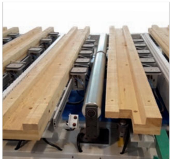
**Saugnäpfe** mit Befestigungssystem durch Vakuum ermöglichen das Festspannen von sehr dünnen Platten.
