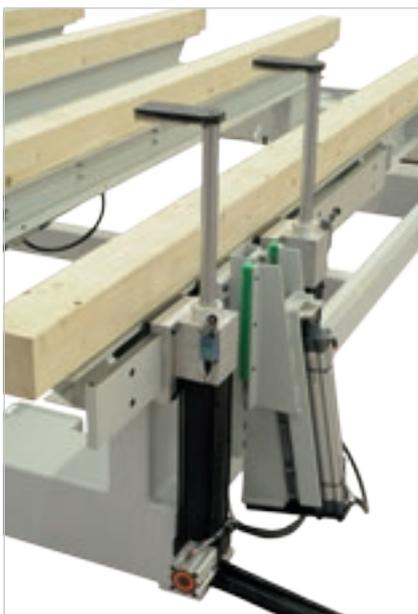
Die **vertikalen Spannbacken** ermöglichen auch das Festspannen von Elementen mit kleinem Querschnitt und erhöhen dadurch die Bearbeitungsflexibilität.
