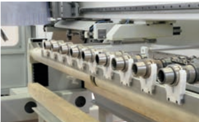
Werkzeugmagazin mit 10 Plätzen für einen schnellen Werkzeugwechsel.
