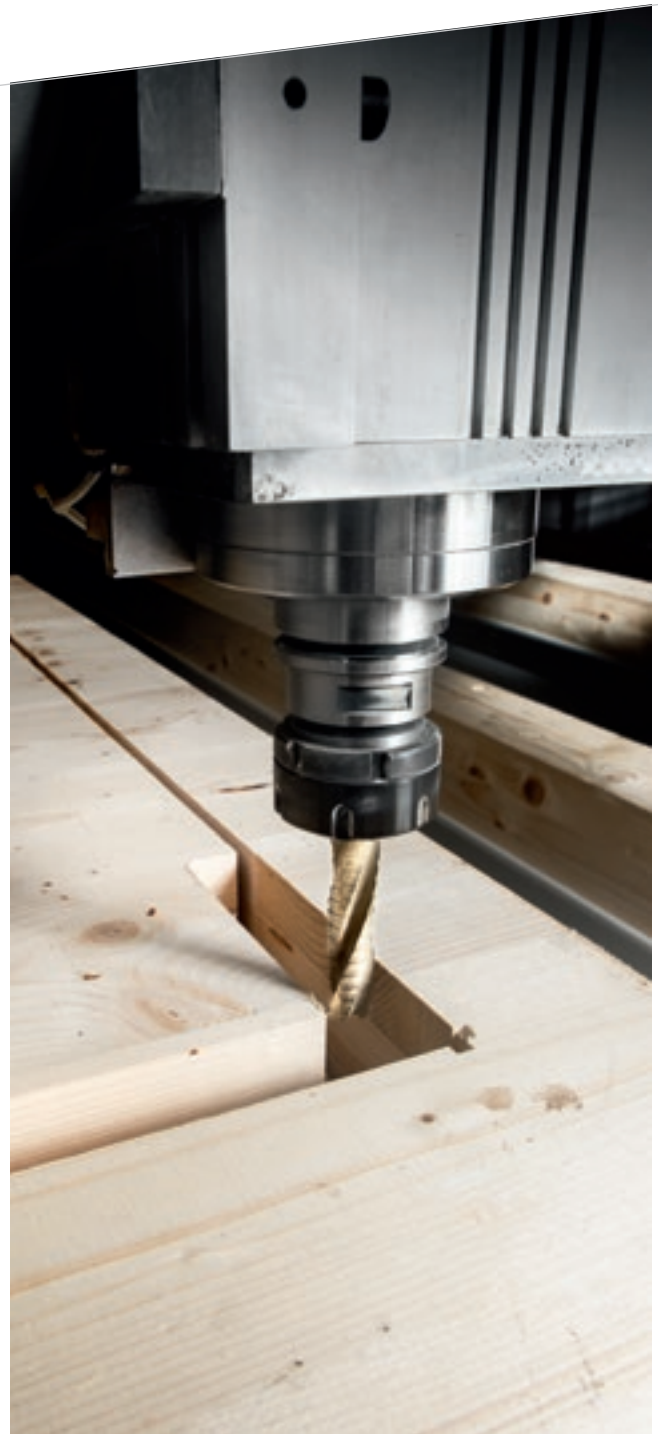
Altas prestaciones gracias al electromandril de 22 kW sincrónico en el eje Y.
