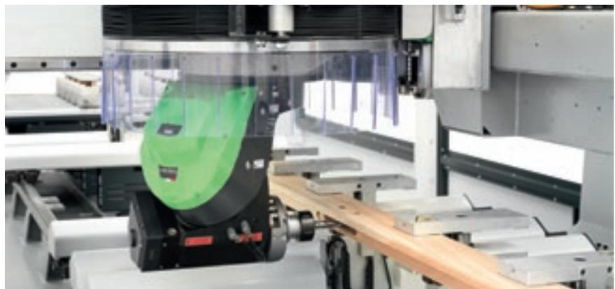
**Kopf mit 5 Achsen** von 16,5 kW zum Kernholz ausgerichtet: Leistung und Stabilität, um schwierige Abtragungen durchzuführen.
