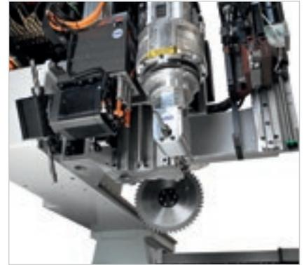
Elektrospindel mit 19,2 kW.
