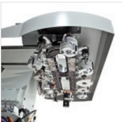
**Fließbandmagazin** mit 22 Positionen und 44 Positionen (opt) mit Abstand von 180 mm.
