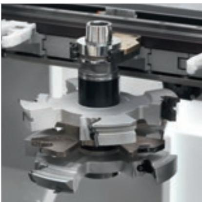
Neuer **verstärkter Metallgreifer** zum Laden von Werkzeugen mit bis zu 10 kg.
