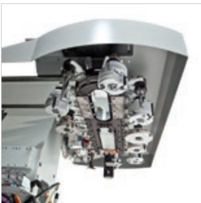
Magasin à chaîne à 22 positions et 44 positions (optionnel) à entraxe de 180 mm.
