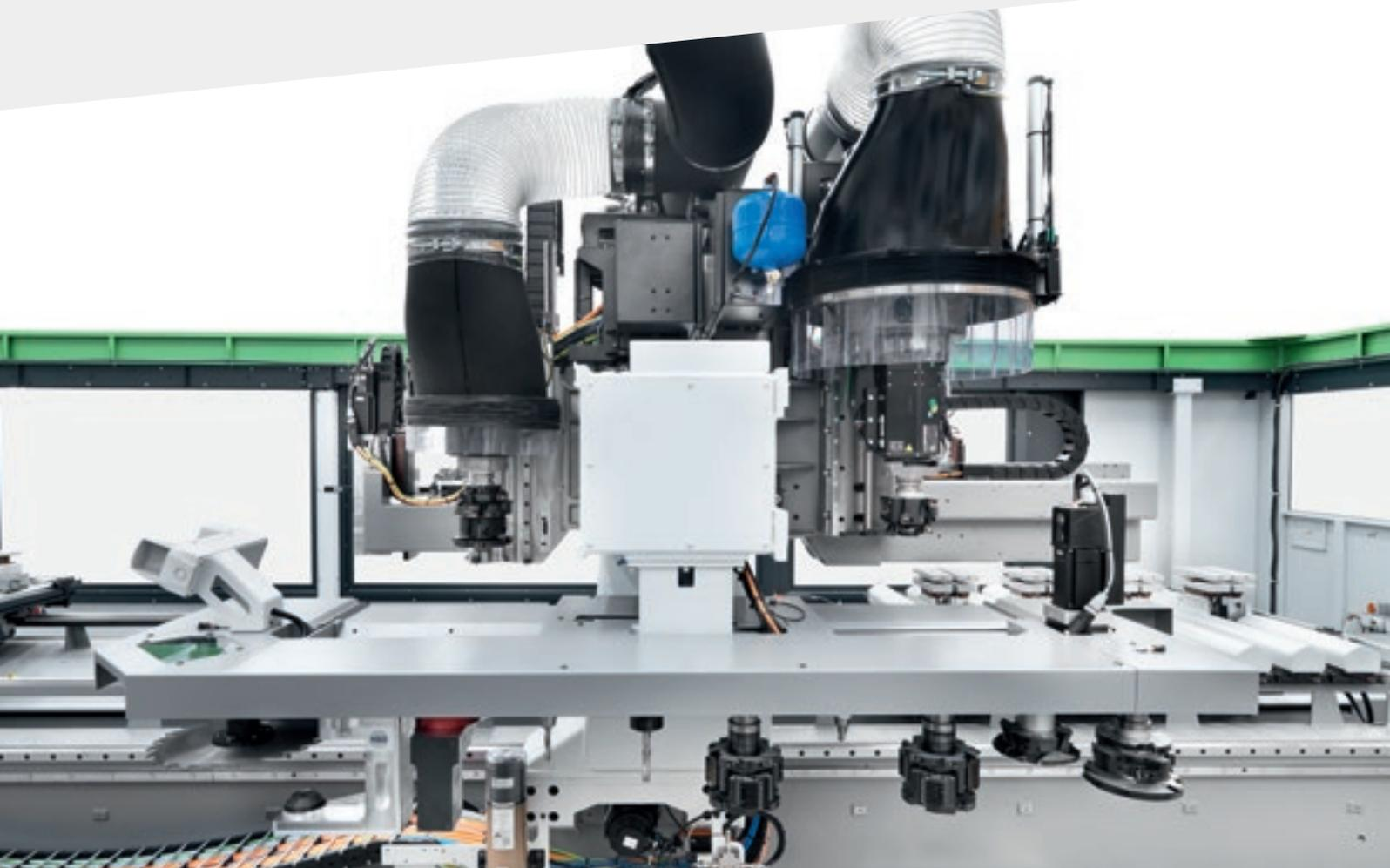
Двойной электрошпindel позволяет производить все возможные смены инструмента в скрытое время, каким бы ни был цикл обработки. Действительно, два шпинделя, расположенные на двух краях каретки, забирают инструмент из одного магазина: пока один шпindel работает, второй производит смену инструмента.
