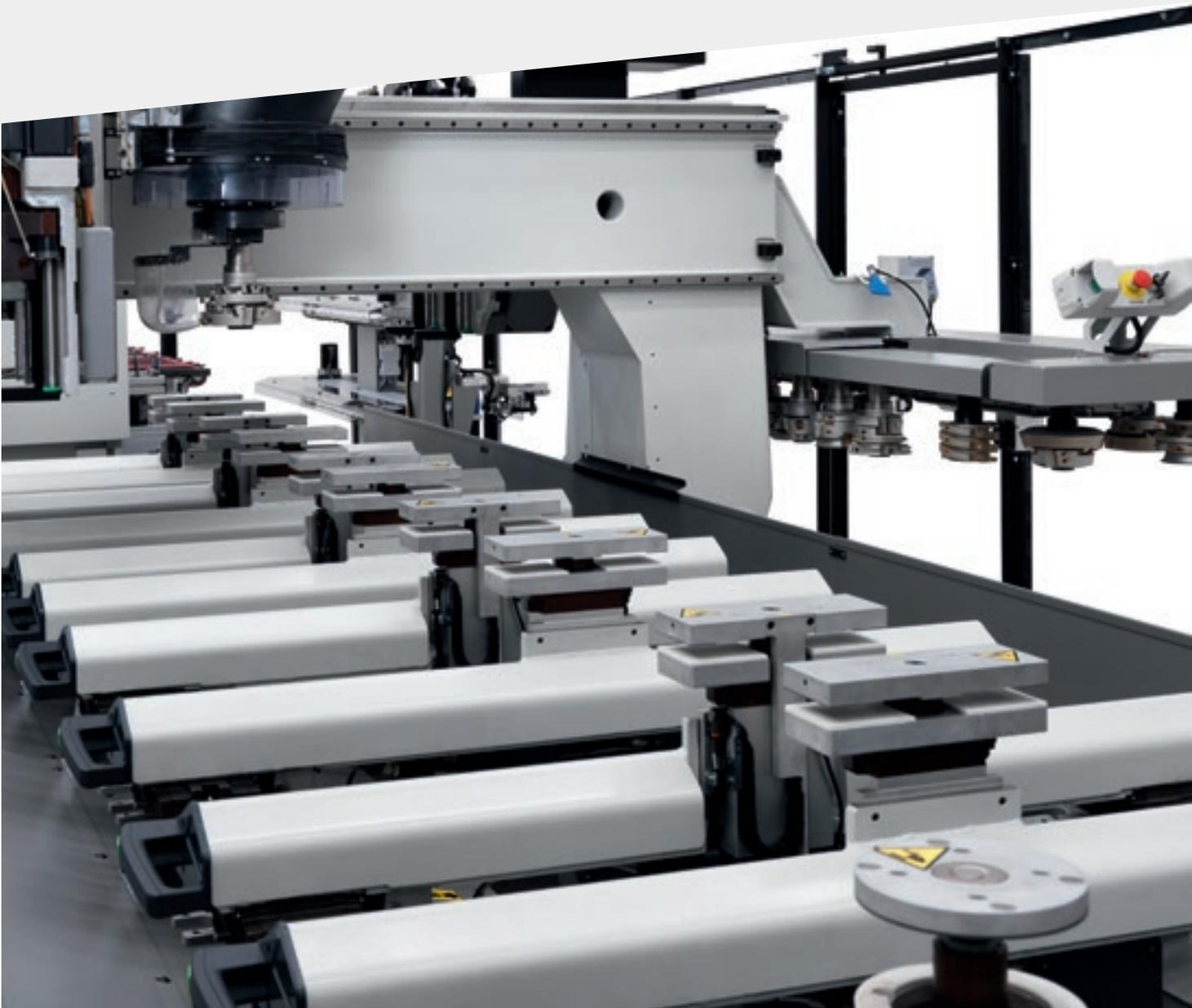
Регулятор давления на зажимах позволяет контролировать силу, прилагаемую к детали в зависимости от её типа. Это позволяет избегать появления каких-либо следов.
