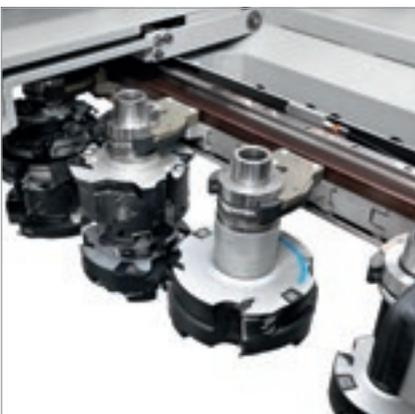
Новая металлическая усиленная цанга для загрузки инструмента до 10 кг.
