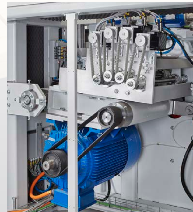
Posizionamento delle lame con motori Brushless
